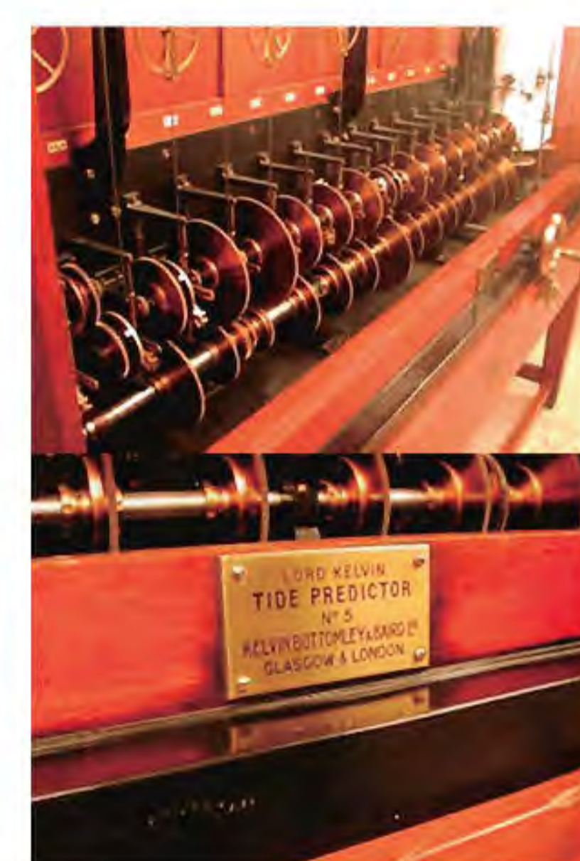
No século XIX Lord Kelvin construiu e aperfeiçoou previsores de marés: máquinas mecânicas que calculavam o nível do mar num dado porto, com base na análise prévia dos dados passados. No Instituto Hidrográfico, em Lisboa, existe uma máquina deste género, construída em Glasgow em 1924.
