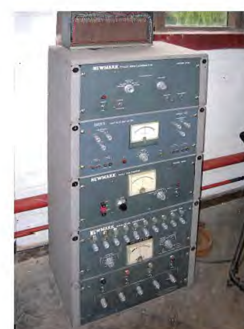
Computador analógico electrónico datado de 1960 (Newmark) utilizado para resolver equações diferenciais.
